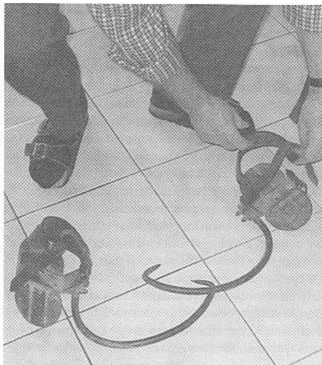
Hulpstukken waarmee Piet Gille de houten palen in krom om de verbindingsdraden aan te leggen of te repareren.
