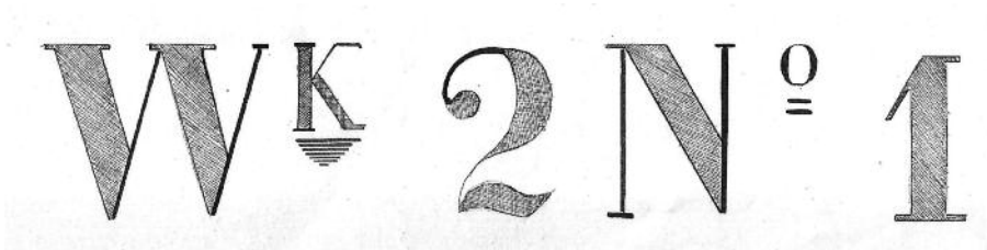
De letters en cijfers te plaatsen op de post van de hoofdingang, ter hoogte van 1.50 M uit den grond gemeten, duidelijk leesbaar ter grootte van 50 mm in zwarte olieverf
